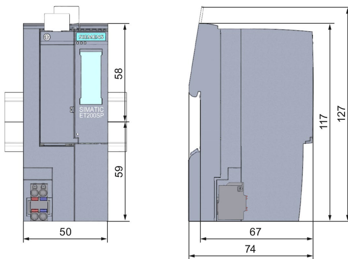
Figura A-1 Croquis acotado del módulo de interfaz IM 155-6 PN ST (vista frontal y lateral)
