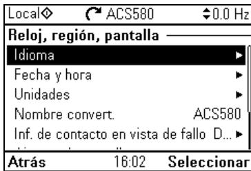
El submenú **Reloj, región, pantalla** contiene ajustes para idioma, fecha y hora, pantalla (p. ej., brillo) y ajustes para cambiar cómo se muestra la información en pantalla.
