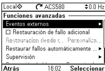
El submenú **Funciones avanzadas** contiene ajustes para funciones avanzadas, como activación o restauración de fallos a través de E/S, supervisión de señales, uso del convertidor con funciones temporizadas o cambio entre distintos conjuntos completos de ajustes.
