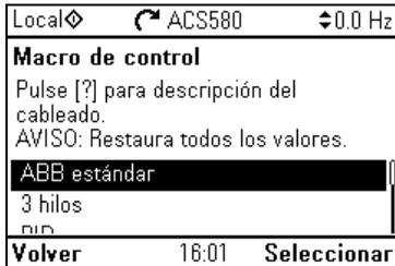
Use el submenú **Macro** para configurar rápidamente el control del convertidor y una fuente de referencia. Para ello, seleccione entre un conjunto predefinido de configuraciones de cableado.
