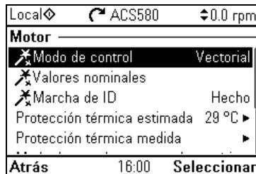
Use el submenú **Motor** para hacer los ajustes relacionados con el motor, como valores nominales, modo de control o protección térmica.
