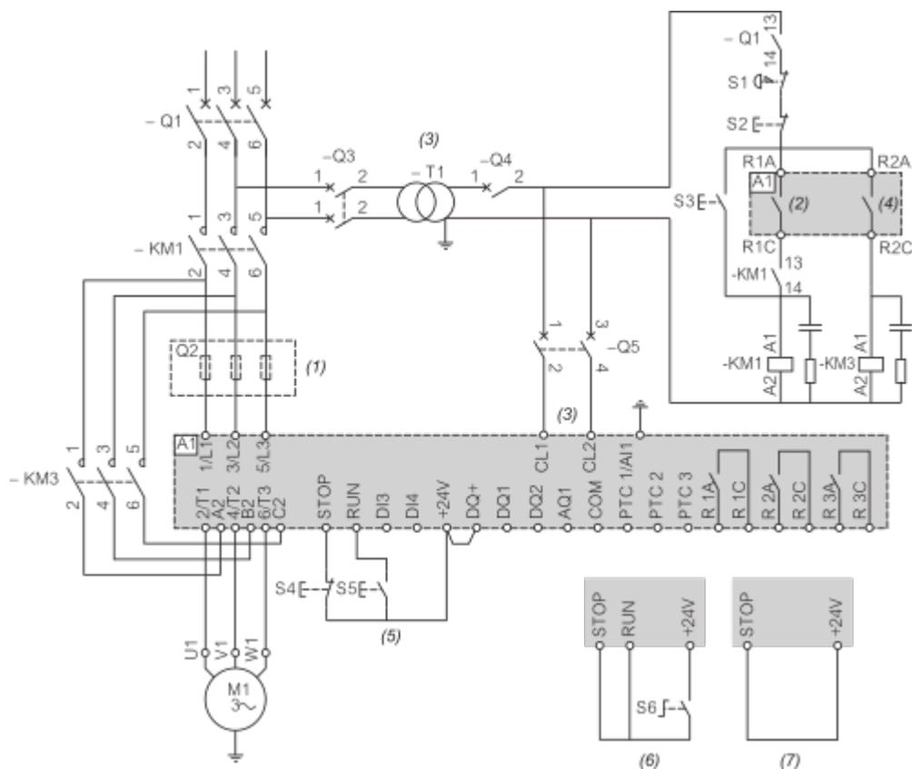
(1): Instalación de fusibles de acción rápida adicionales para mejorar la coordinación de tipo 2 de acuerdo con la norma IEC 60947-4-2.
