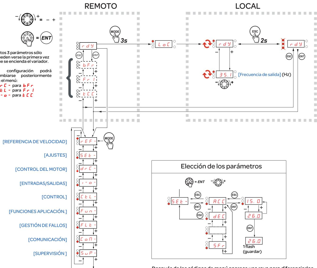
Nota : el variador vuelve a la configuración REMOTO tras el funcionamiento con el ajuste de fábrica ([Restaurar config.] (FCS)) o modificando la macroconfiguración ([Macroconfiguración] (CFG)).
