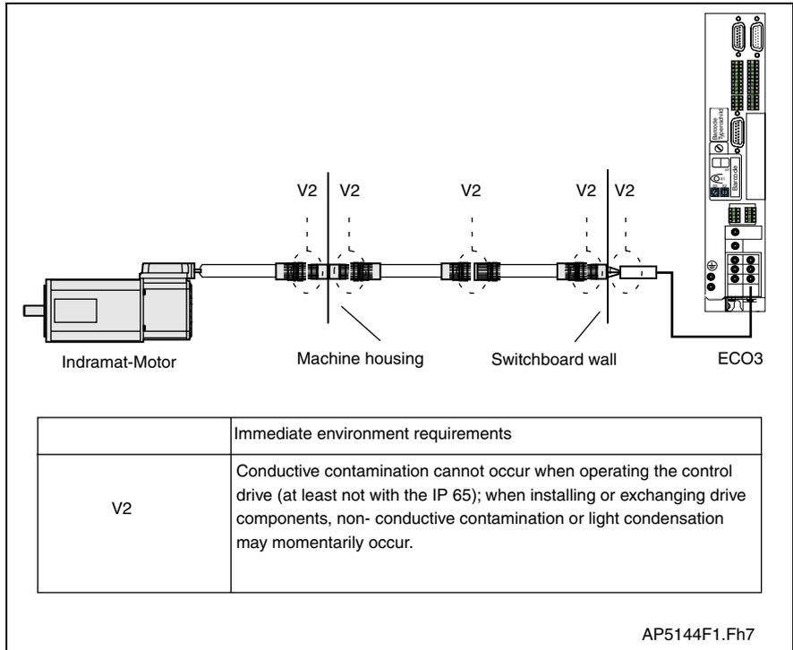
Fig. 15-2: Dirt contamination per DIN VDE 0160
