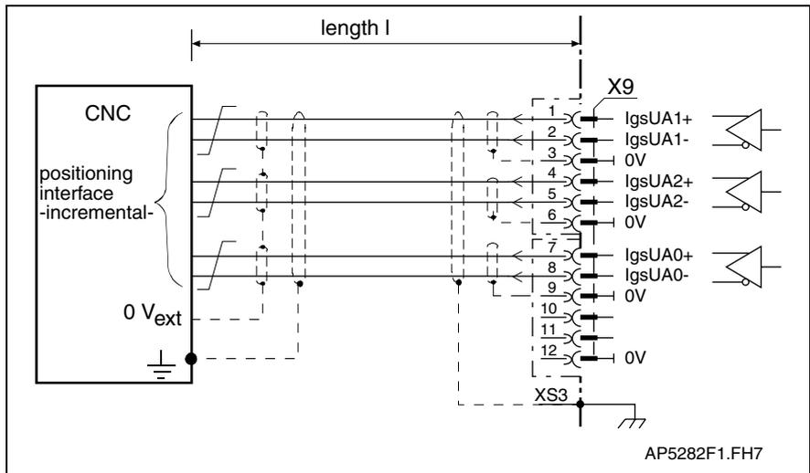
Fig. 4-125: Connection of incremental actual position value output
