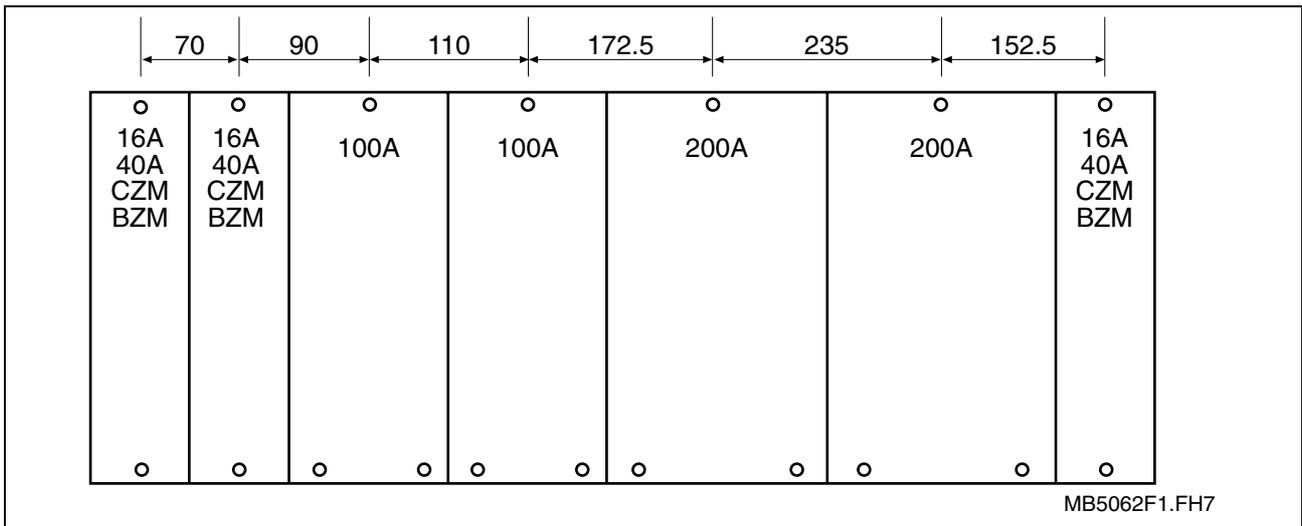
Fig. 12-16: Module widths
