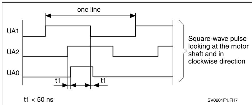
Fig. 4-127: Signal for incremental actual position value output
