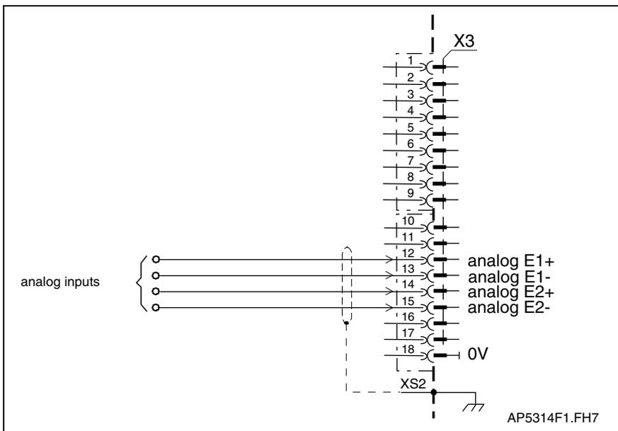
Fig. 4-76: Analog inputs
